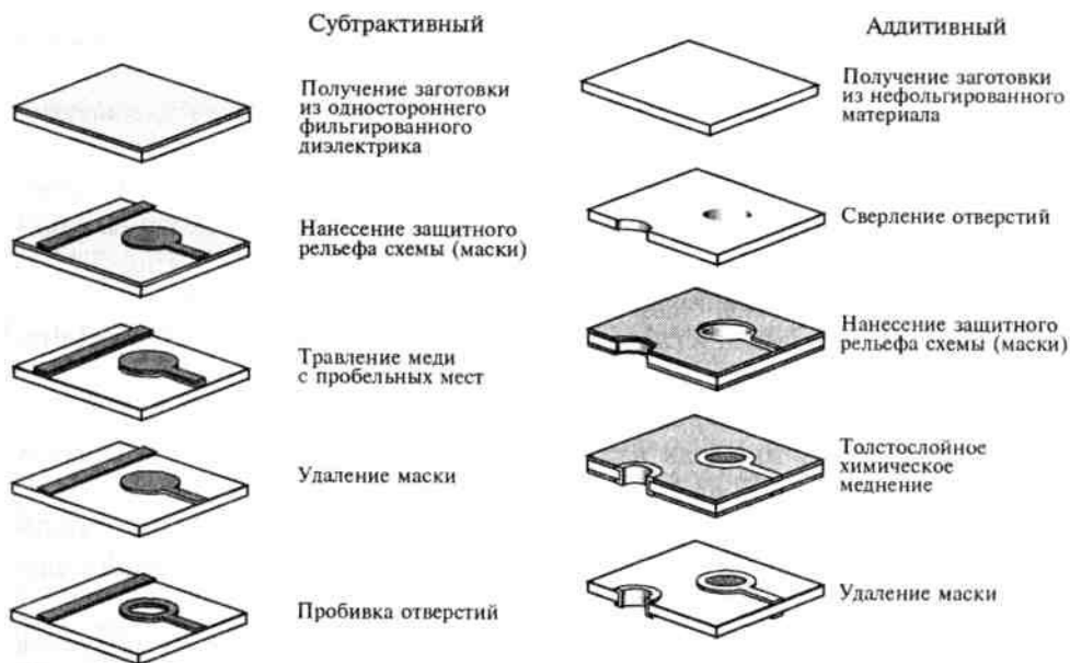
Рис. 4.4. Методы изготовления проводящих слоев печатных плат
